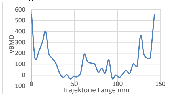
Abb. 2: Beispielhafter Verlauf des mittleren vBMD über Länge der Transiliosakralen Trajektorie (Segmentdimension h=4 \times D=5 mm)
