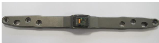
Abb. 1: Modifizierte Osteosyntheseplatte mit eingebauter Telemetrieelektronik und DMS
