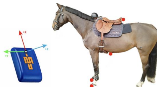
Abb. 1: Vicon Blue Trident [4] (links); Position der Inertialen Messeinheiten am Pferd (rechts)
