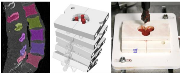
Abb. 1: Segmentierung (links), CAD-Entwurf (Mitte) und Probenentnahme (rechts)
