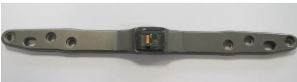
Abb. 1: Modifizierte Osteosyntheseplatte mit eingebauter Telemetrieelektronik und DMS
